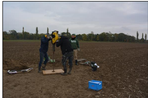
Foto 2: Mit Hilfe der Rammkernsonde können Bohrkerne aus größeren Tiefen geborgen werden. Diese geben wichtige Rückschlüsse über die spätquartäre Entwicklung der Region.
